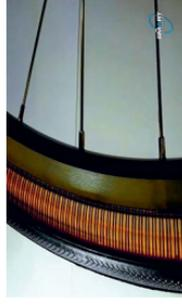
циальной пружины Slinky и внешней оболочки для нее, которая изготовлена из материала на основе резины и принимает на себя все воздействие окружающей среды, поэтому ее срок службы составляет 8 — 12 тыс. км пробега.
