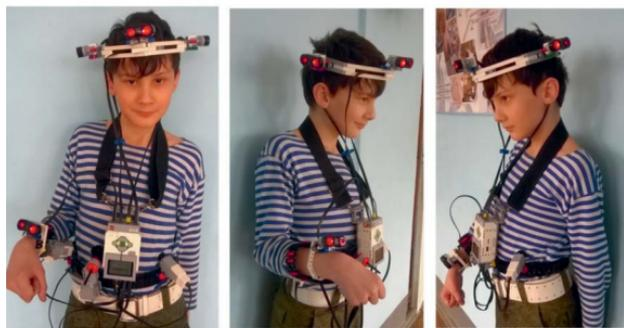
ствия высотой более 120 см. При этом срабатывание моторов прямо пропорционально расстоянию до препятствия. Если препятствие высотой менее 120 см, то срабатывает датчик на запястье руки.
