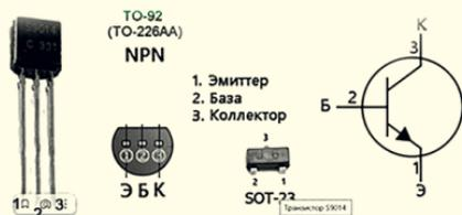
Рис. 9. Расположение выводов SMD-транзистора S9014.
